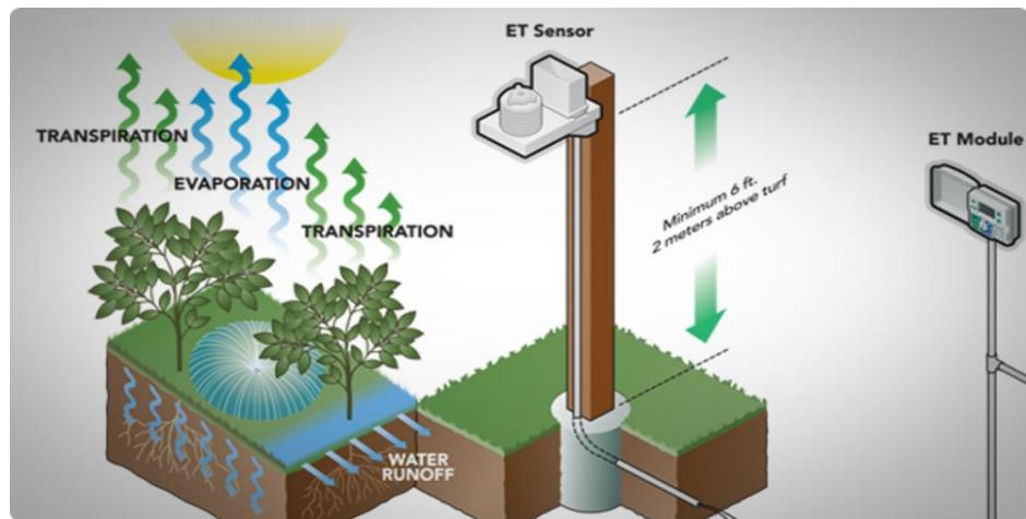
Sastoji se od unutarnje i vanjske jedinice. Vanjska jedinica ima senzorski sistem koji uključuje jačinu sunčevog zračenja, relativnu vlagu, temperaturu, količinu oborina i optionalno anemometar. U unutarnjoj jedinici se za svaki ventilski izlaz namještaju podaci o biljnem materijalu, terenu i pokrivenosti terena vodom ovisno o vrsti emitera.
