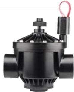
Na vrhu se nalazi vijak za regulaciju protoka. Solenoid za primitak signala sa programatora na 230V je od 24 V, za prijam signala sa baterijskog programatora je od 9V. Na ventil se može montirati ACCU SYNC regulator pritiska.
