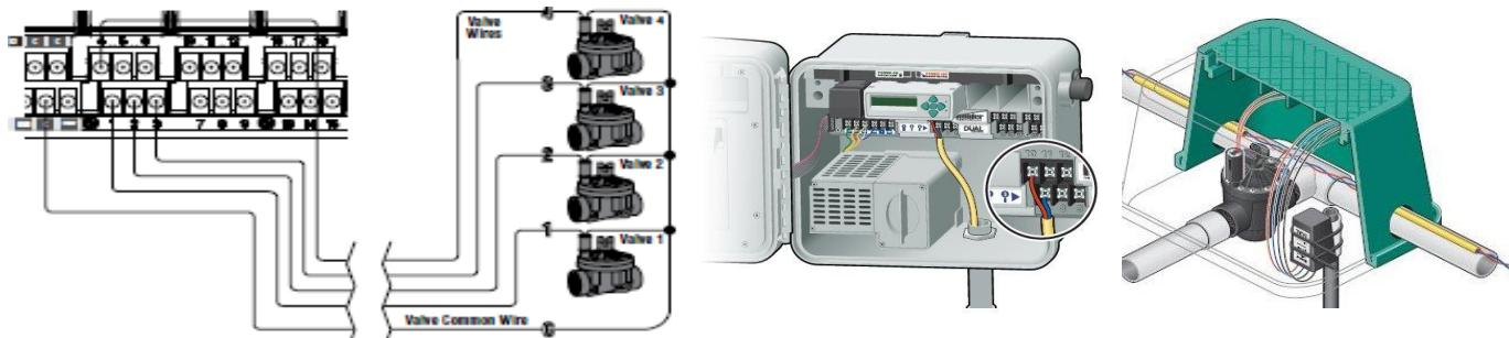
Modularni programator se spaja sa ventilima kao i fiksni sa po jednom žicom elektrokabla za svaki ventil koja se priključi na svoje mjesto na modulu, te jednom zajedničkom žicom kabela za sve ventile koja se priključi na mjesto označeno C na terminalu glavnog modula.
